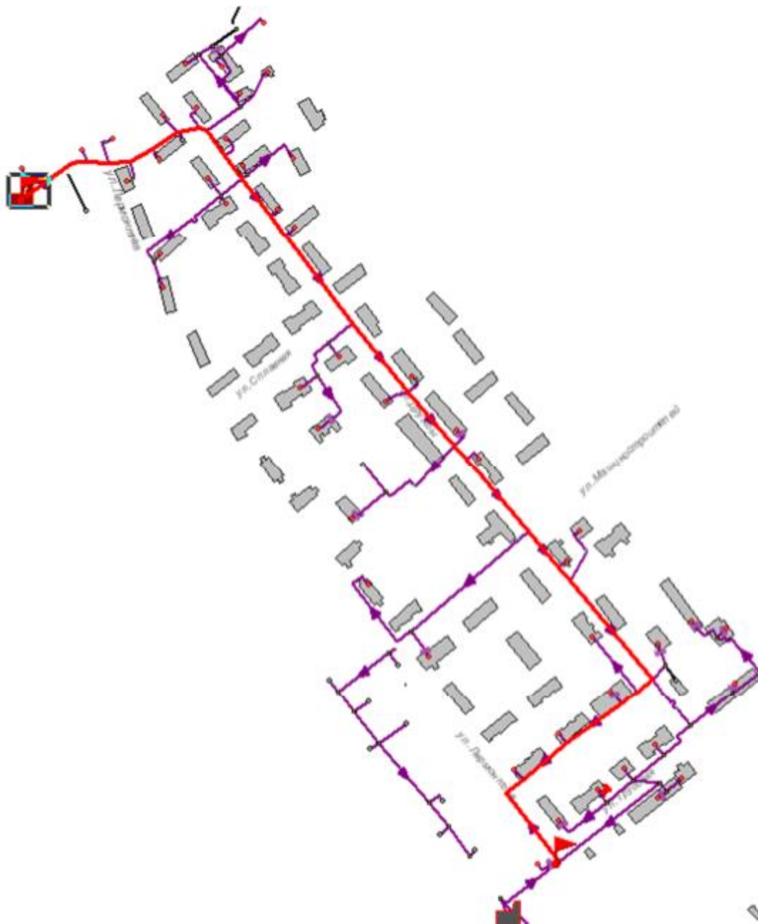
Рисунок 1.33 -Расчетный путь теплоносителя котельной до Лермонтова 23, стр.20
