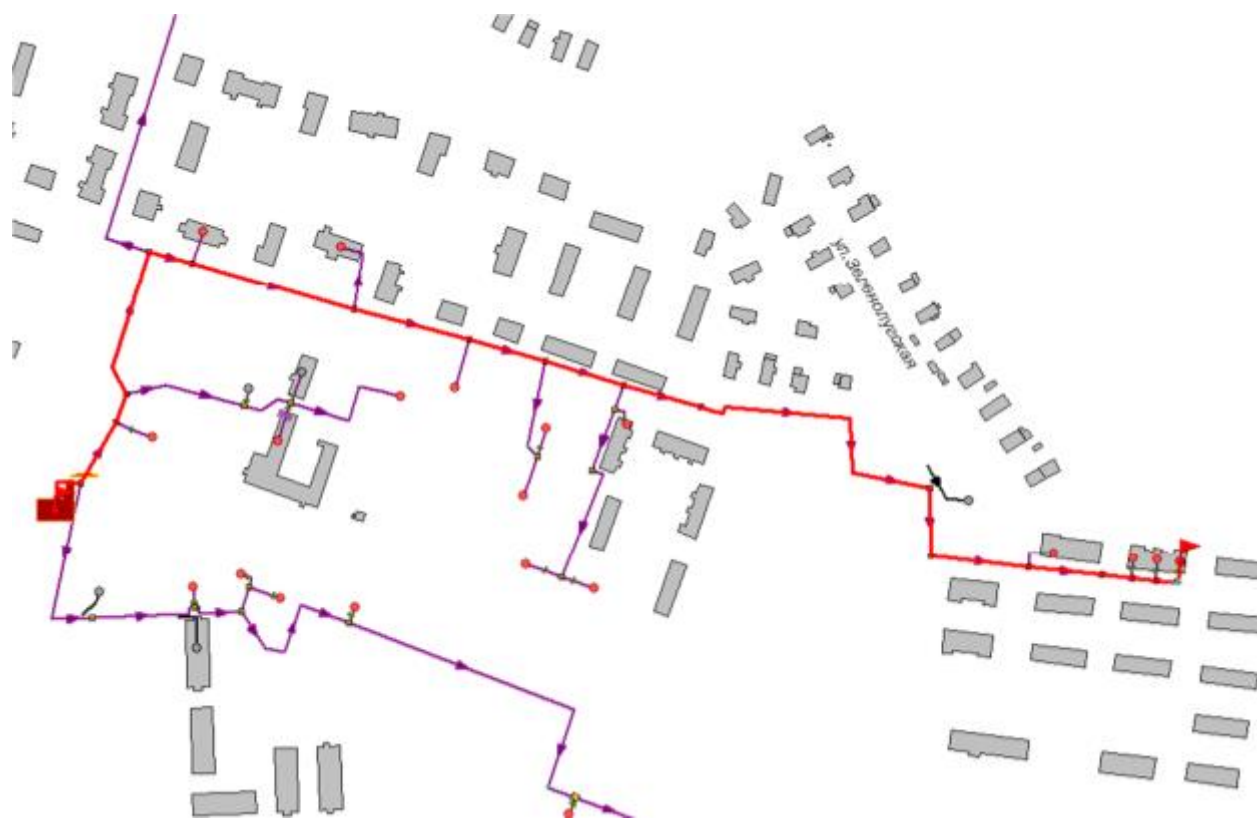
Рисунок 1.13 -Расчетный путь теплоносителя котельной до КЛДК 23, УУ1
