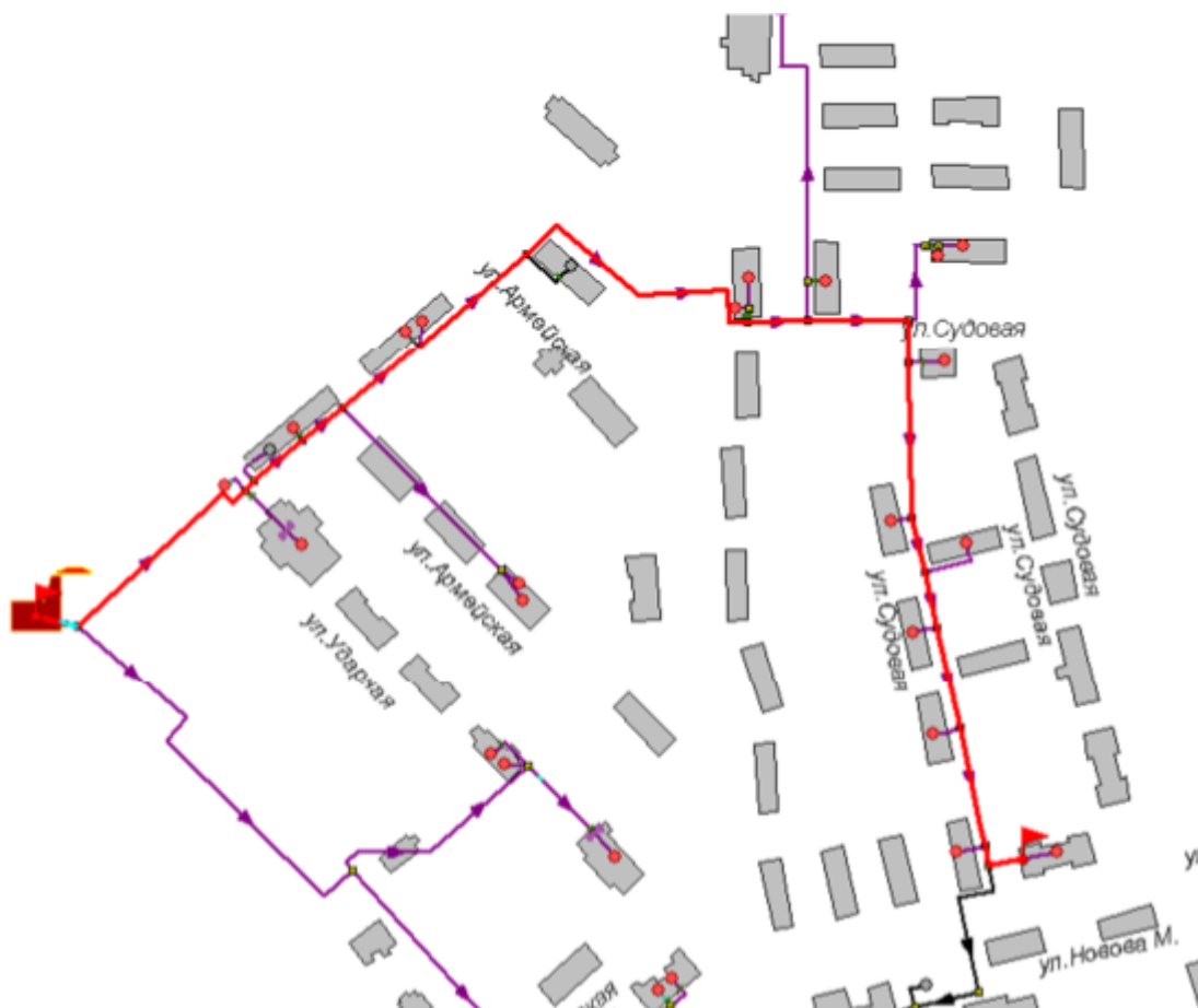
Рисунок 2.87 -Расчетный путь теплоносителя от котельной до Новова,17
