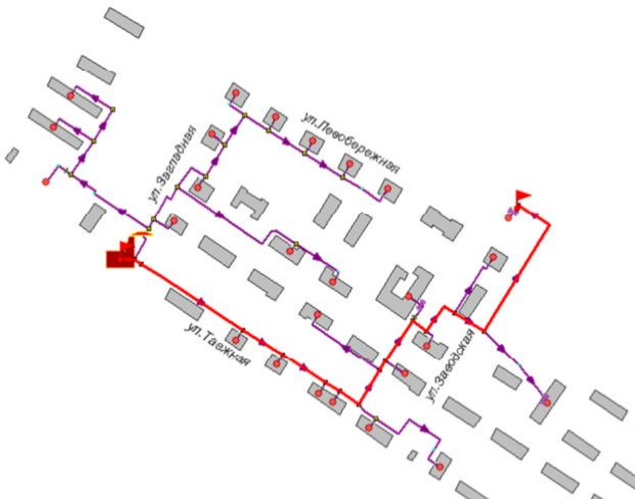
Рисунок 2.57 -Расчетный путь теплоносителя котельной до Турдево,ПЧ-70
