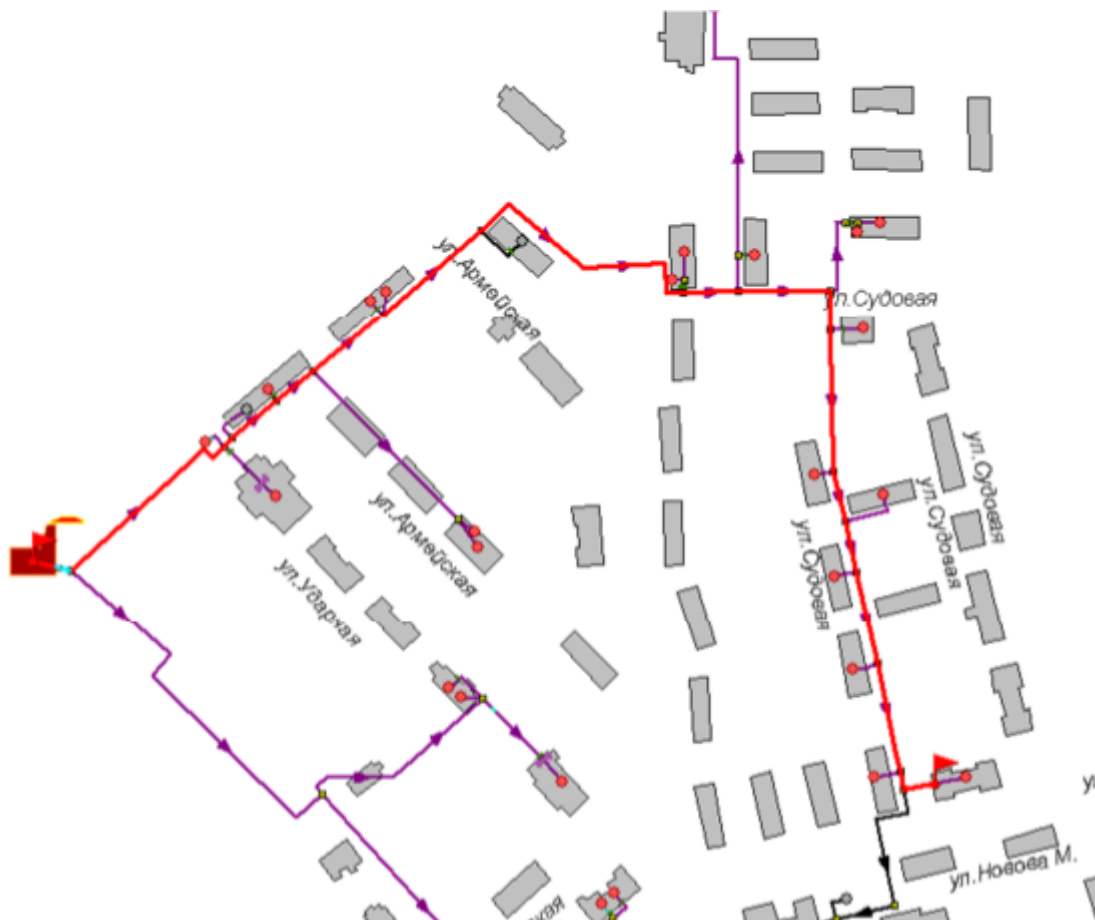
Рисунок 3.87 -Расчетный путь теплоносителя от котельной до Новова,17
