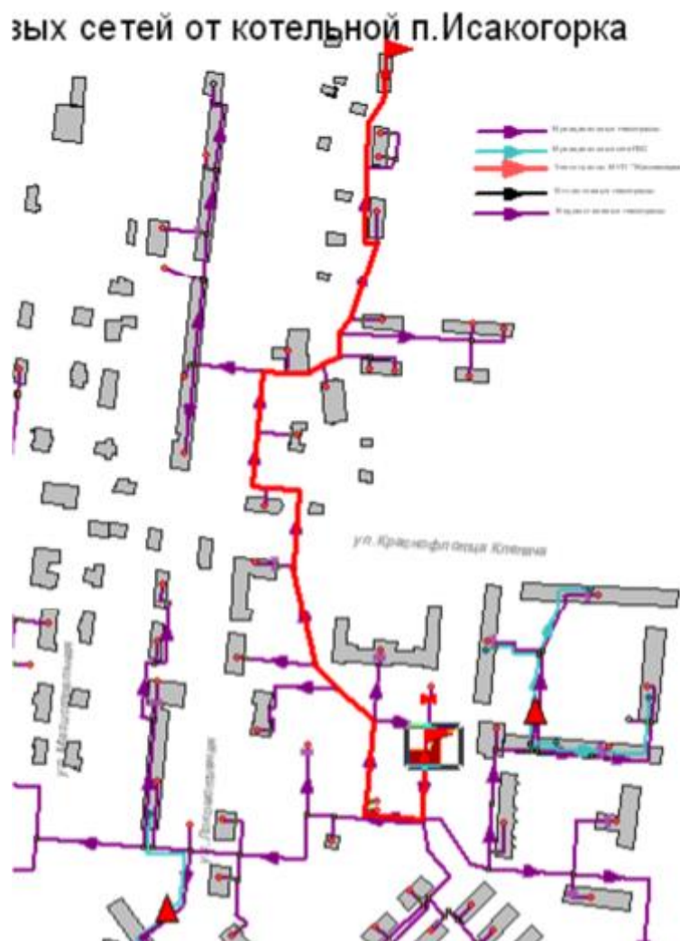
Рисунок 2.49 -Расчетный путь теплоносителя от котельной до Локомотивная,1
