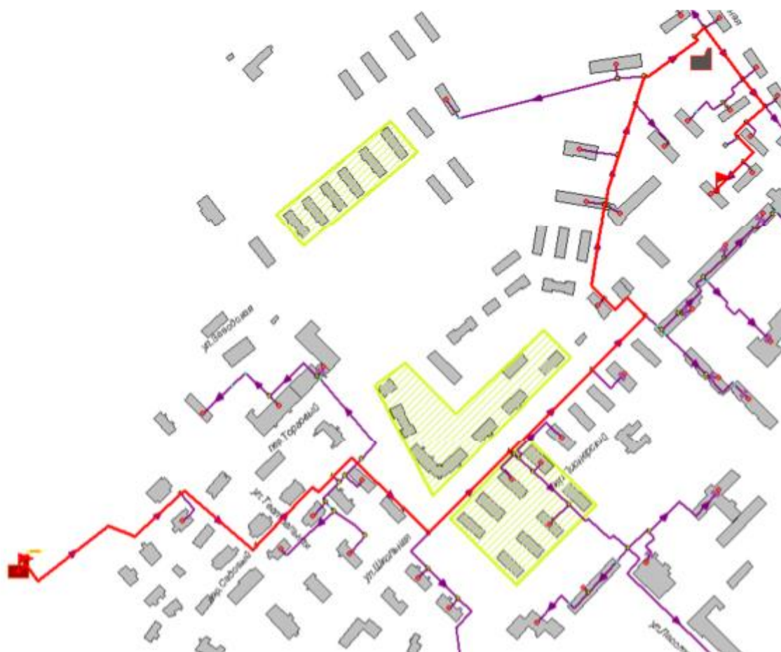
Рисунок 1.85 -Расчетный путь теплоносителя котельной до Школьная,162
