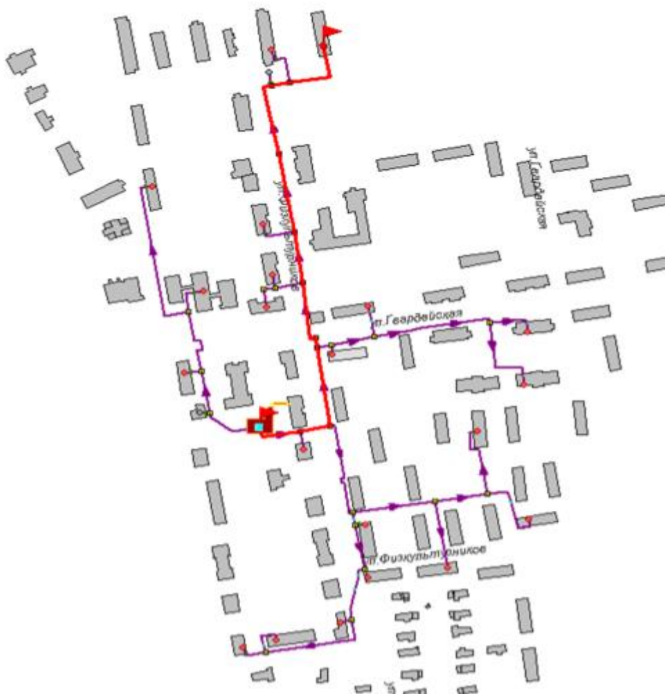
Рисунок 3.71 -Расчетный путь теплоносителя от котельной до Петрова,9
