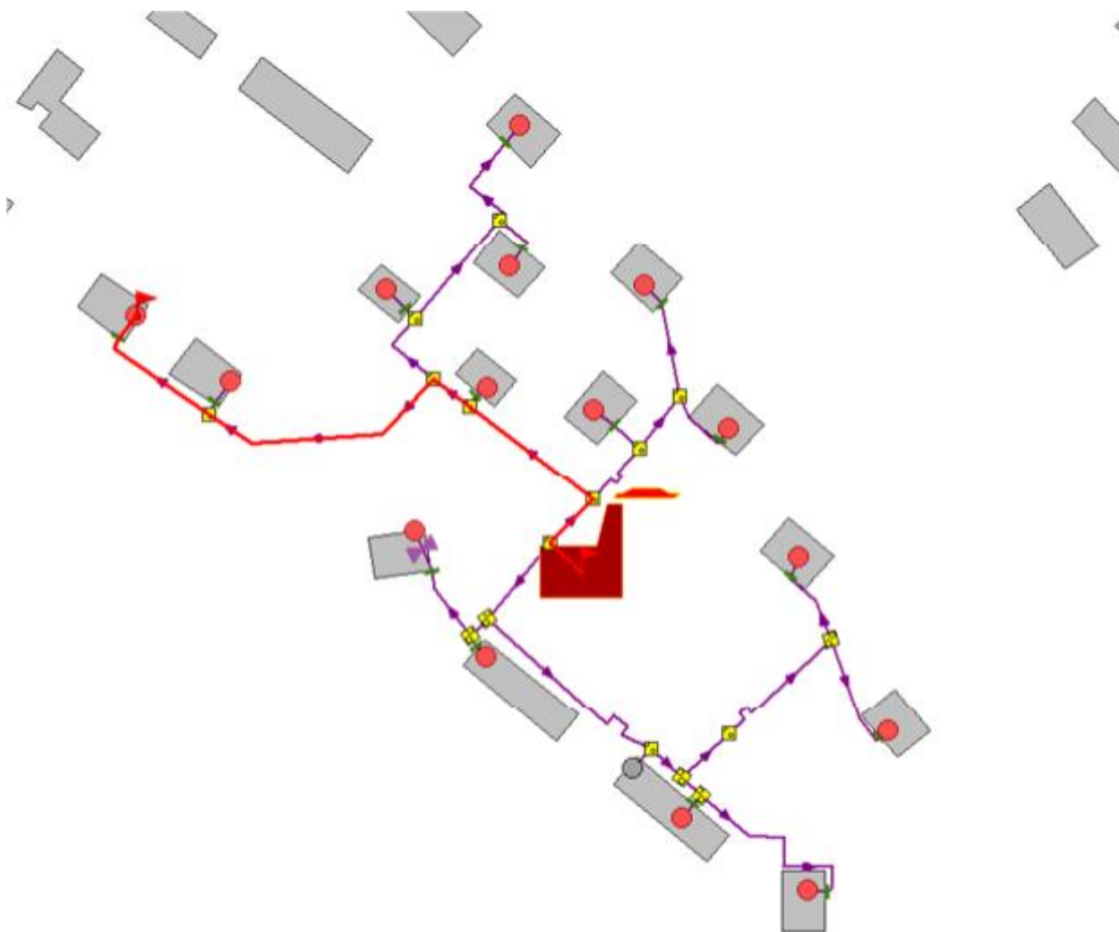
Рисунок 3.19 -Расчетный путь теплоносителя котельной до Дрейера, 15 к.3
