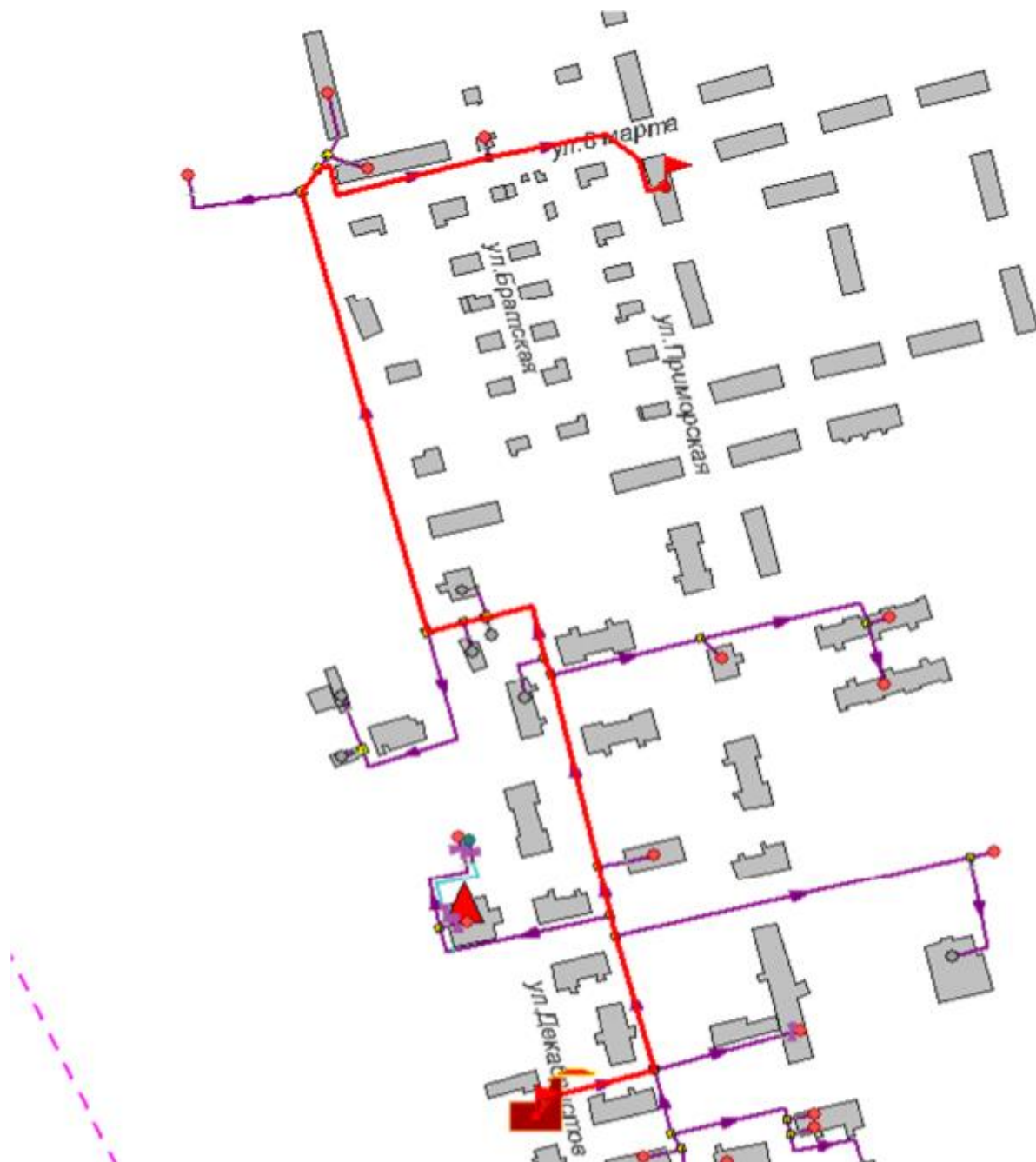
Рисунок 1.63 -Расчетный путь теплоносителя от котельной до Приморская,16
