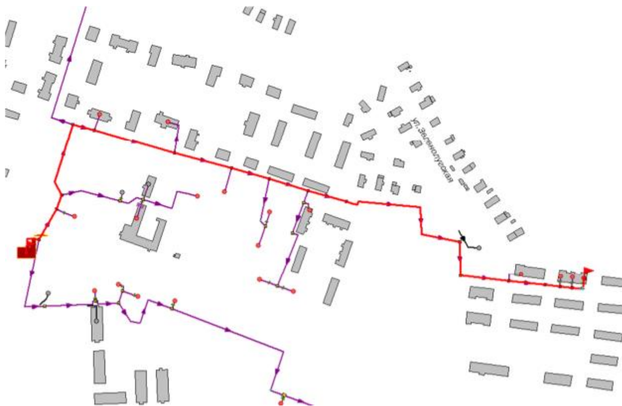
Рисунок 2.13 -Расчетный путь теплоносителя котельной до КЛДК 23, УУ1
