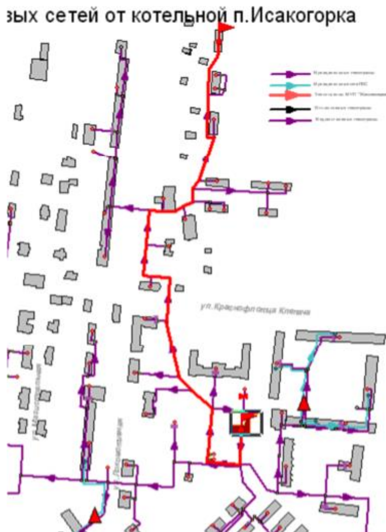
Рисунок 1.49 -Расчетный путь теплоносителя от котельной до Локомотивная,1
