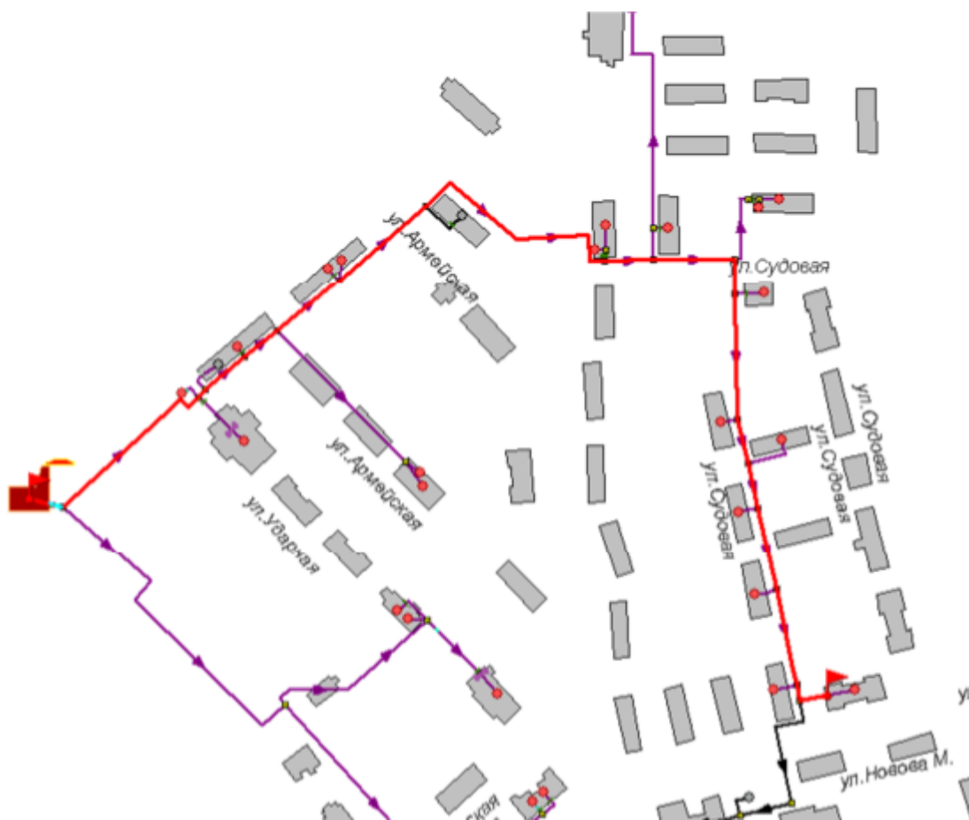
Рисунок 1.87 -Расчетный путь теплоносителя от котельной до Новова,17
