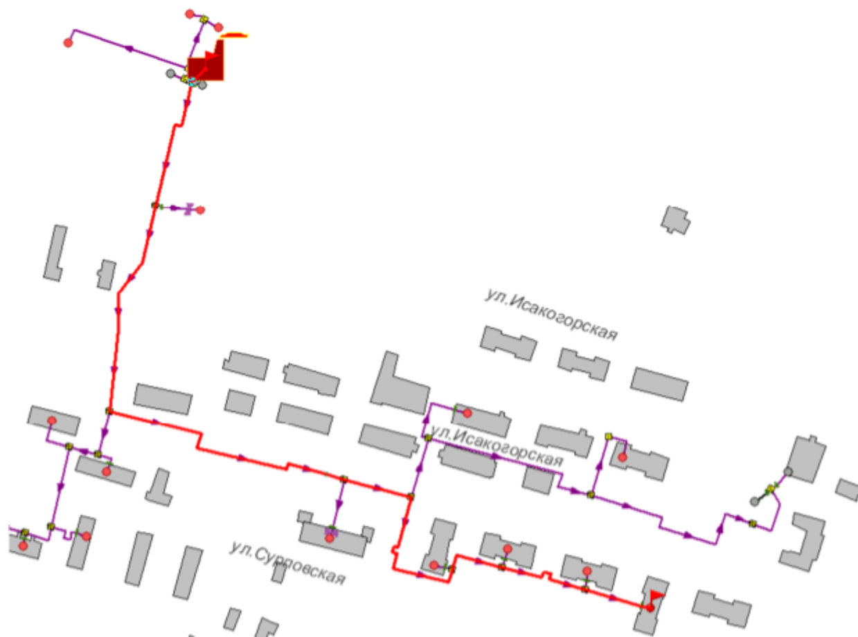
Рисунок 1.17 -Расчетный путь теплоносителя котельной до Сурповской, 20
