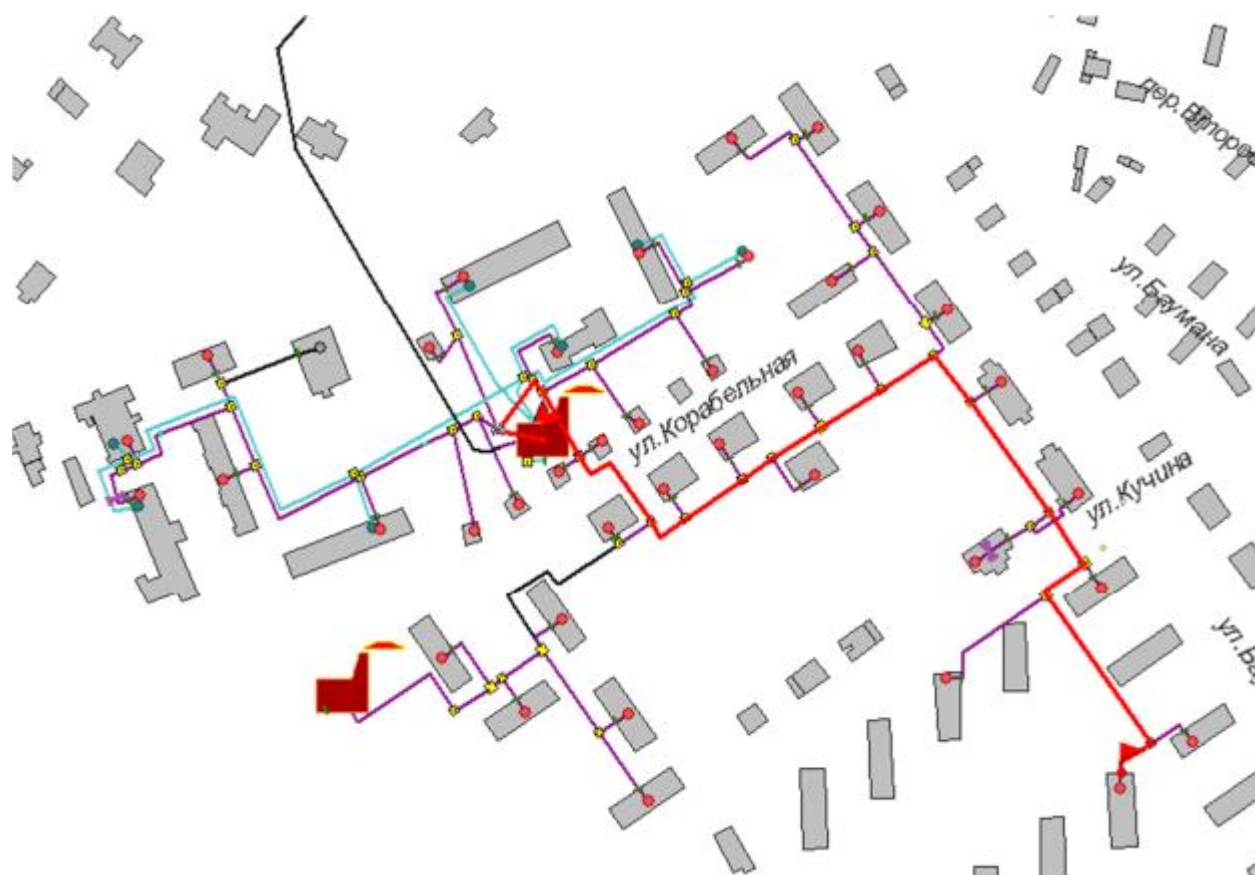
Рисунок 3.75 -Расчетный путь теплоносителя котельной до Баумана,12 к.4
