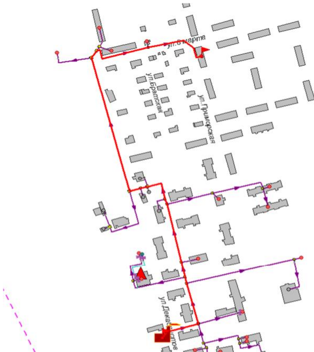
Рисунок 2.63 -Расчетный путь теплоносителя от котельной до Приморская,16
