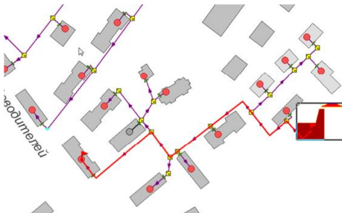
Рисунок 1.43 -Расчетный путь теплоносителя котельной до Речников,29
