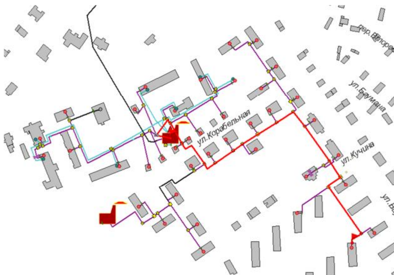
Рисунок 1.75 -Расчетный путь теплоносителя котельной до Баумана,12 к.4
