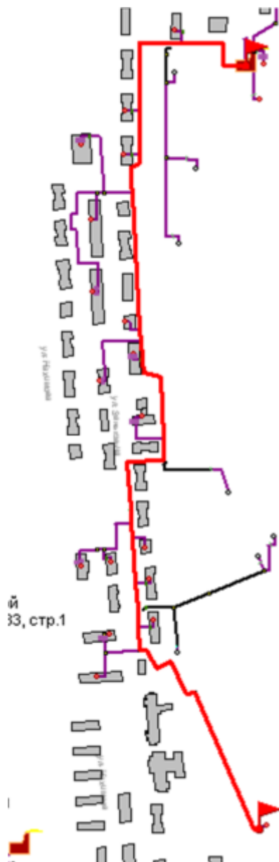
Рисунок 3.29 -Расчетный путь теплоносителя котельной до Пластмассового завода
