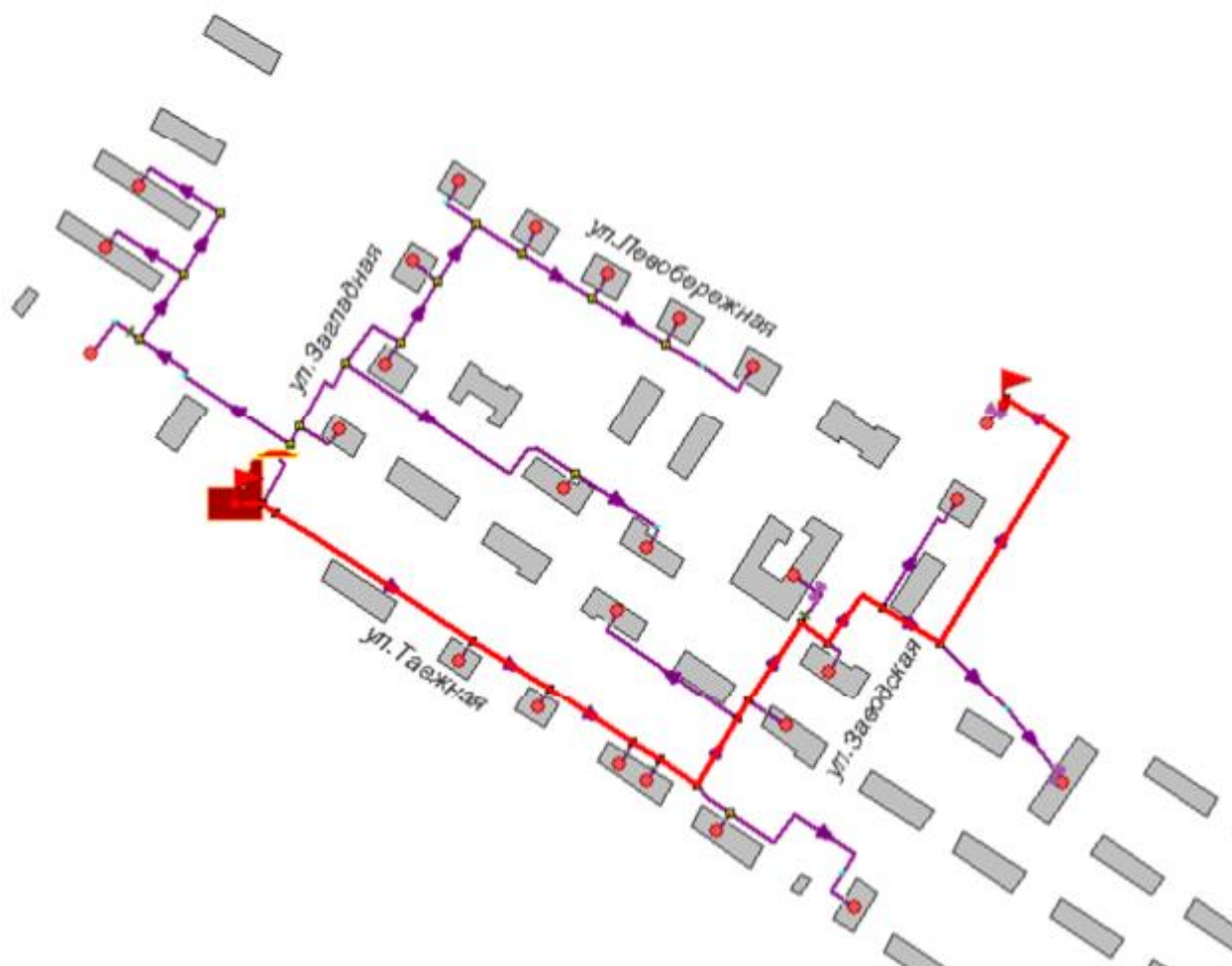
Рисунок 1.57 -Расчетный путь теплоносителя котельной до Турдеево,ПЧ-70
