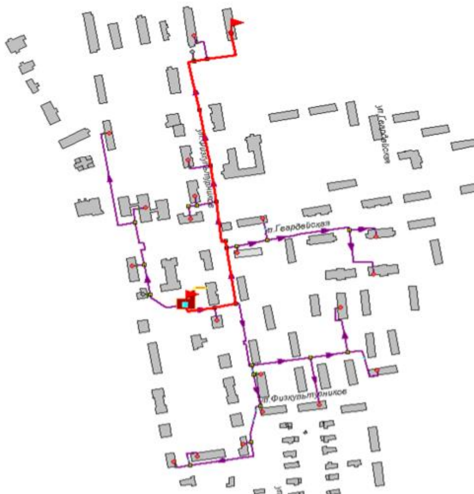
Рисунок 1.71 -Расчетный путь теплоносителя от котельной до Петрова,9
