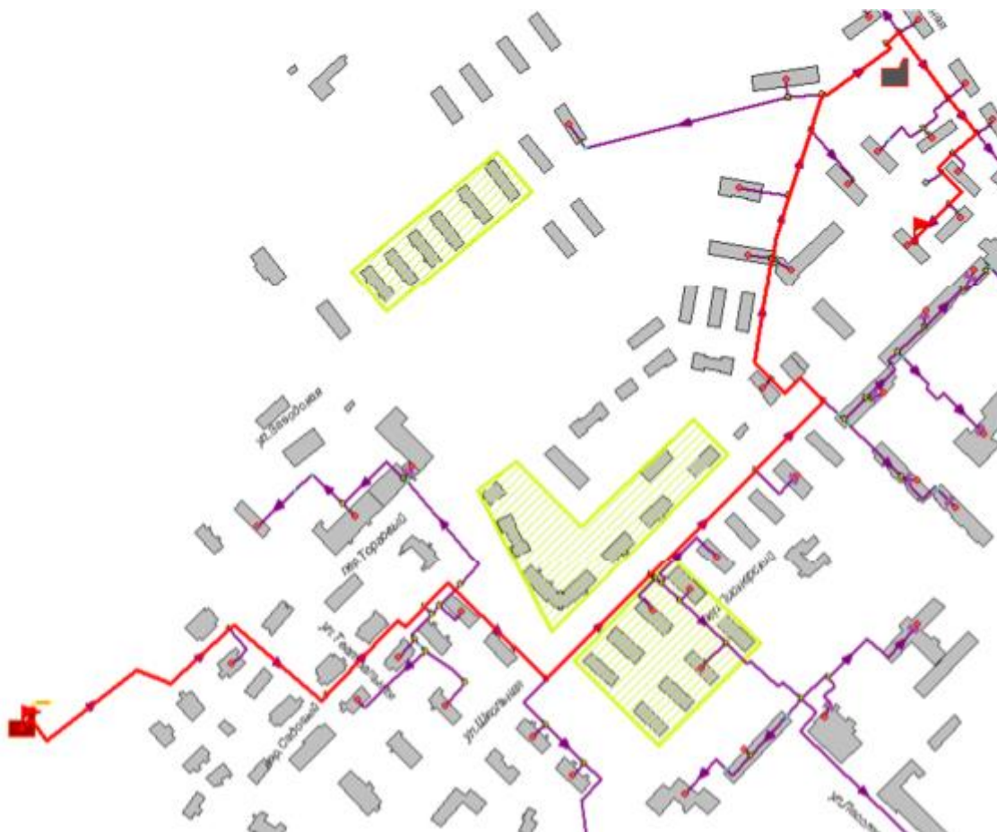
Рисунок 3.85 -Расчетный путь теплоносителя котельной до Школьная,162
