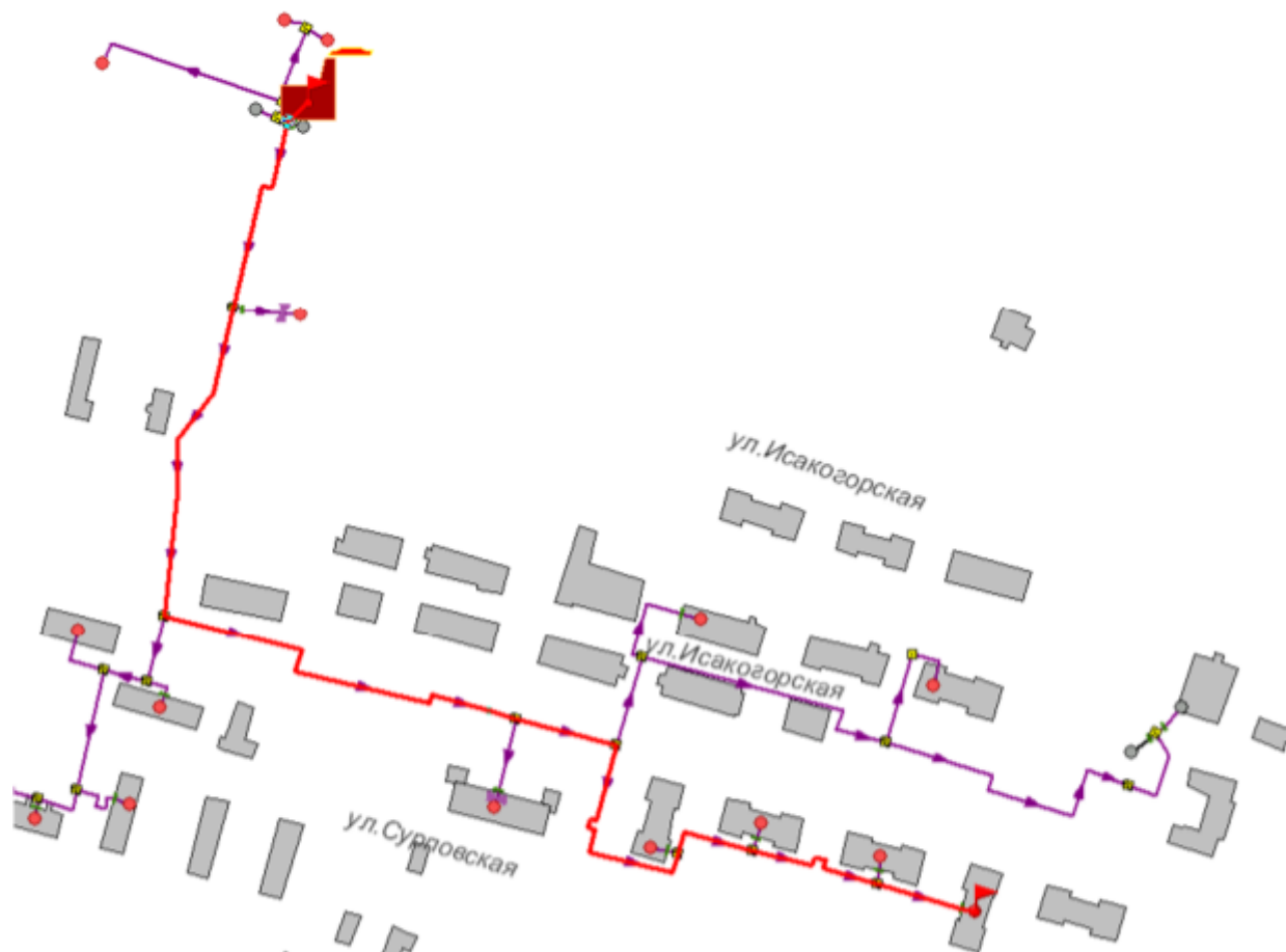
Рисунок 3.17 -Расчетный путь теплоносителя котельной до Сурповской, 20
