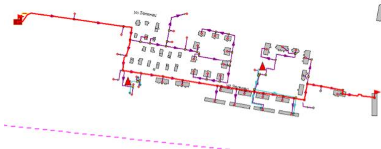
Рисунок 1.15 -Расчетный путь теплоносителя котельной до Зеленец, 1 к.1
