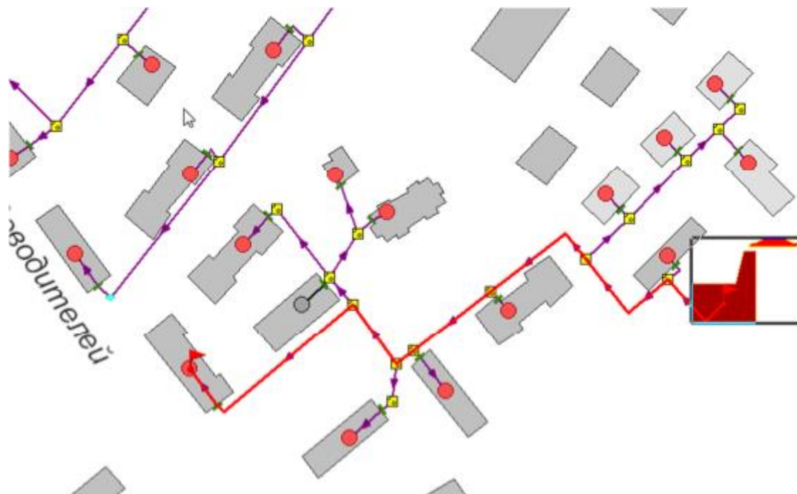
Рисунок 3.43 -Расчетный путь теплоносителя котельной до Речников,29
