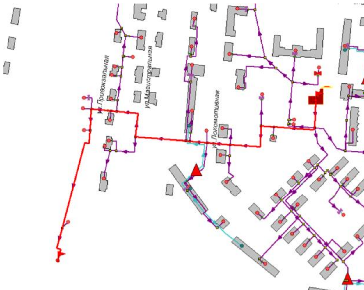
Рисунок 3.47 -Расчетный путь теплоносителя от котельной до Привокзальная, 19
