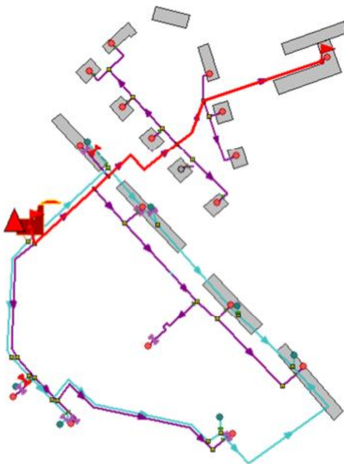
Рисунок 1.53 -Расчетный путь теплоносителя котельной до Лахтинское шоссе,135
