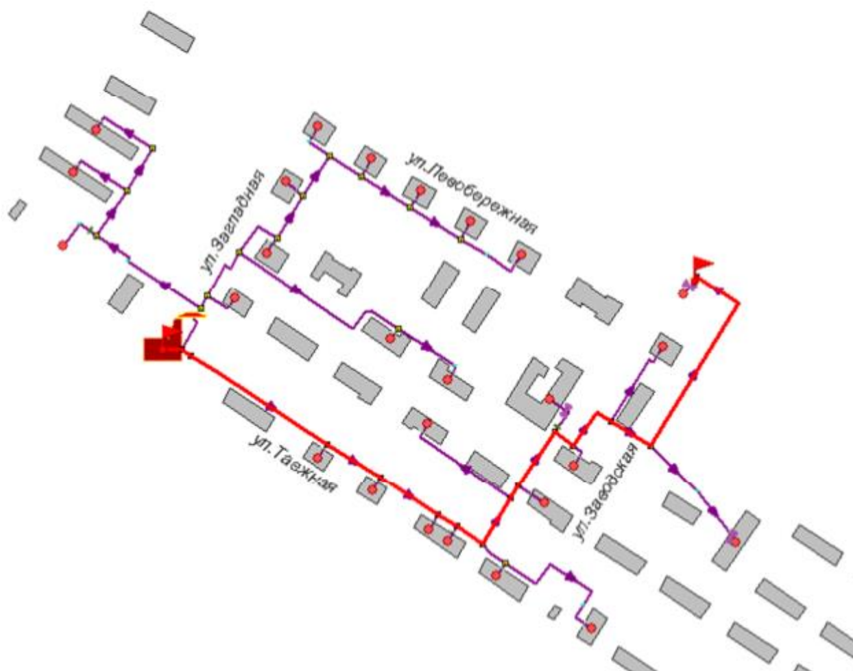
Рисунок 3.57 -Расчетный путь теплоносителя котельной до Турдево,ПЧ-70
