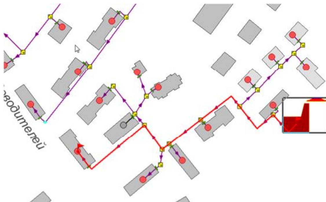
Рисунок 2.43 -Расчетный путь теплоносителя котельной до Речников,29
