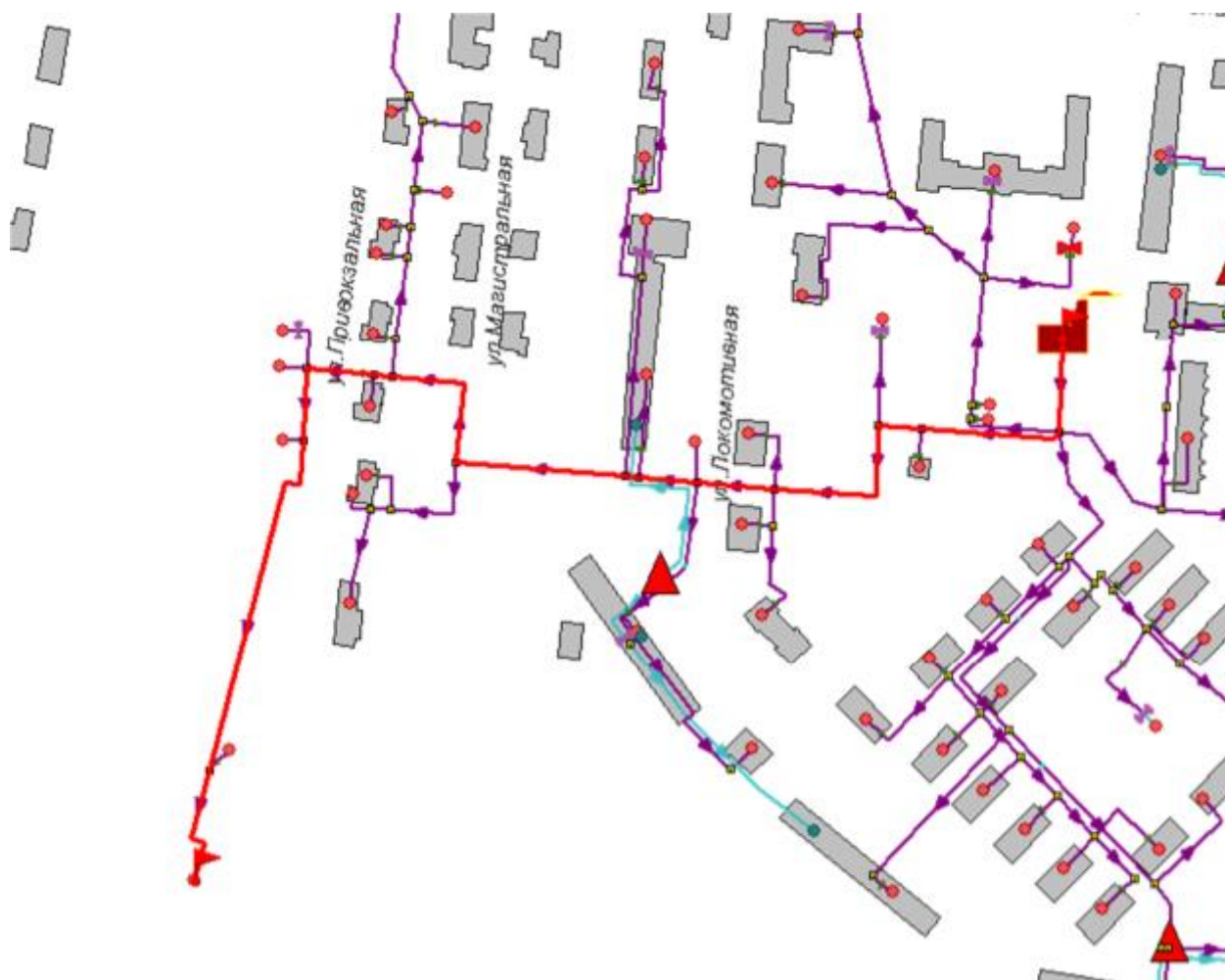
Рисунок 1.47 -Расчетный путь теплоносителя от котельной до Привокзальная, 19
