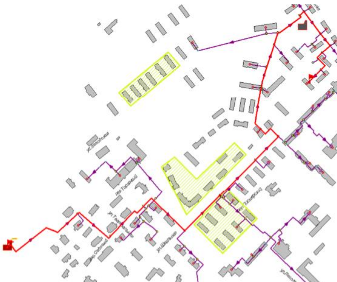
Рисунок 2.85 -Расчетный путь теплоносителя котельной до Школьная,162
